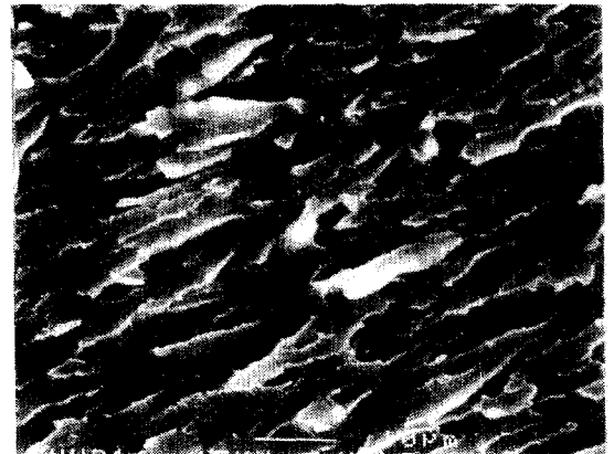
사진 8. (Epoxy/MA) 수지 100[phr]/PU 수지 15[phr] 시편의 전자 현미경 사진 Photo 8. SEM of specimen with (Epoxy/MA)resin 100[phr]/PU resin 15[phr]
