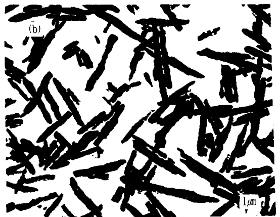
그림 2. 비디오테이프의 전형적인 구조와 자성체 입자의 투과전자현미경 사진
