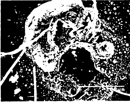
사진 1. P-마이카의 관통혈 (SEM 200 배율) Photo 1. Penetration hole due to break-down in P-mica (Magnification : 200, SEM)
