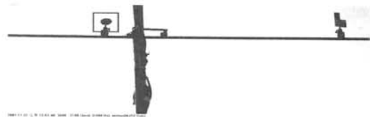
그림 2. 고속카메라를 이용한 전차선 상부 마커의 영상취득 사진.
