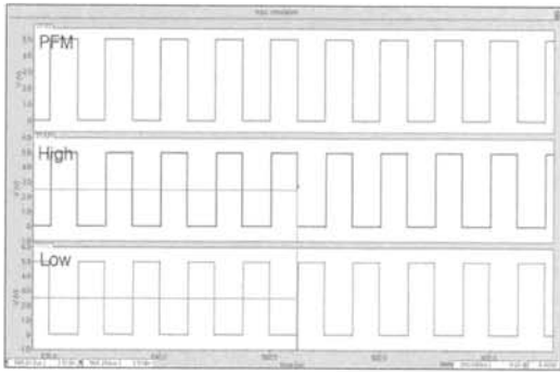
그림 9. 제안한 쏘트-스루 보호회로의 입-출력 특성 Fig. 9. Input-output characteristics of proposed shoot-through protection circuit.
