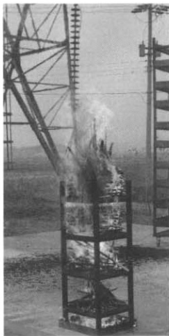
그림 3. 온도 센서 취부와 시험 장면(무가압). Fig. 3. Installation of thermocouple and simulation test(un-energized).
