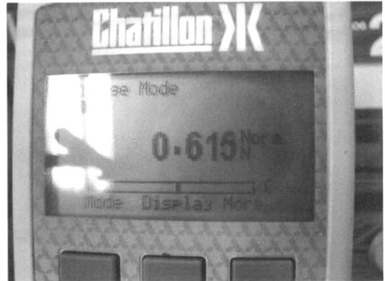
그림 11. 일체형 인치웜 방식 액츄에이터의 발생력. Fig. 11. Force generated in MITA.
