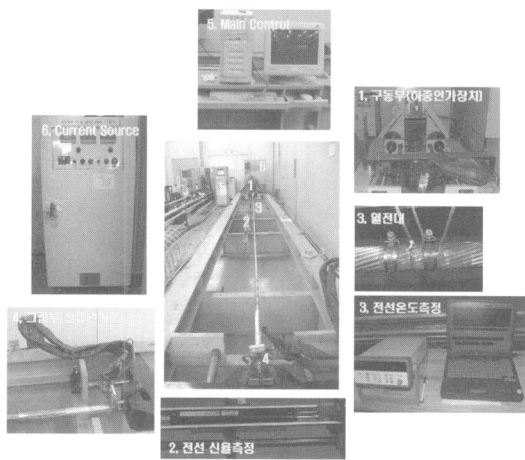
그림 2. 가공송전선 고온인장시험전경. Fig. 2. Outline of high temperature tensile test of ACSR 410 mm 2 conductor.
