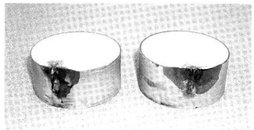
그림 6. 장시간 방전내량 시험후의 파괴사진.
