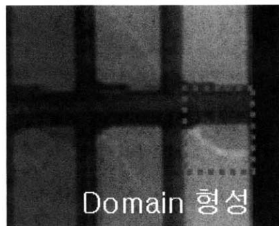
그림 6. TN 모드의 박막 트랜지스터 주변에서 도메인 형성. Fig. 6. Domain formation around the TFT at TN mode.
