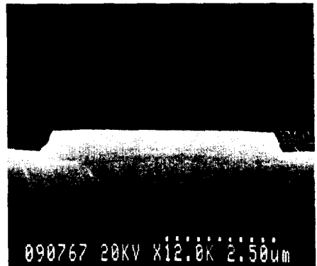
그림 6. Cl_2/(Cl_2+Ar)=0.8 에서 식각된 YMnO_3 박막의 SEM 단면 사진.
