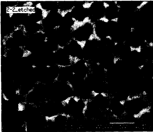
그림 2. 1.46 wt% HF, 0.8 wt% H 2 O 2 전해질에서 5 V의 전압을 30분 동안 인가한 후의 SiC 기판 표면을 찍은 SEM사진.
