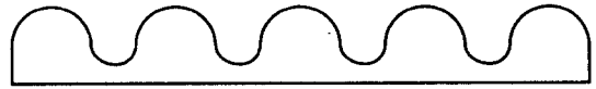
그림 3 노광 후 광폴리머의 표면 구조 Fig. 3 Surface structure of photopolymer after photolithograph
