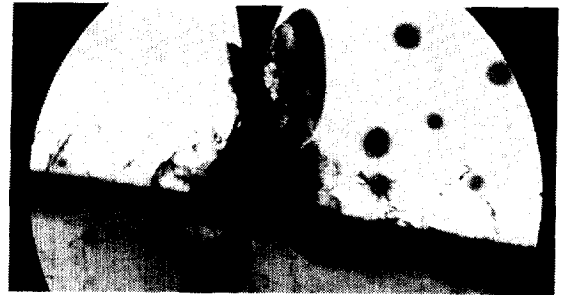
그림 10. 계면에서의 가스누설 Fig. 10. Gas leakage from the interface
